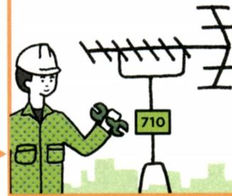
ブースターへのフィルターの取付け(またはブースター交換)および対策箇所の撮影をいたします。
